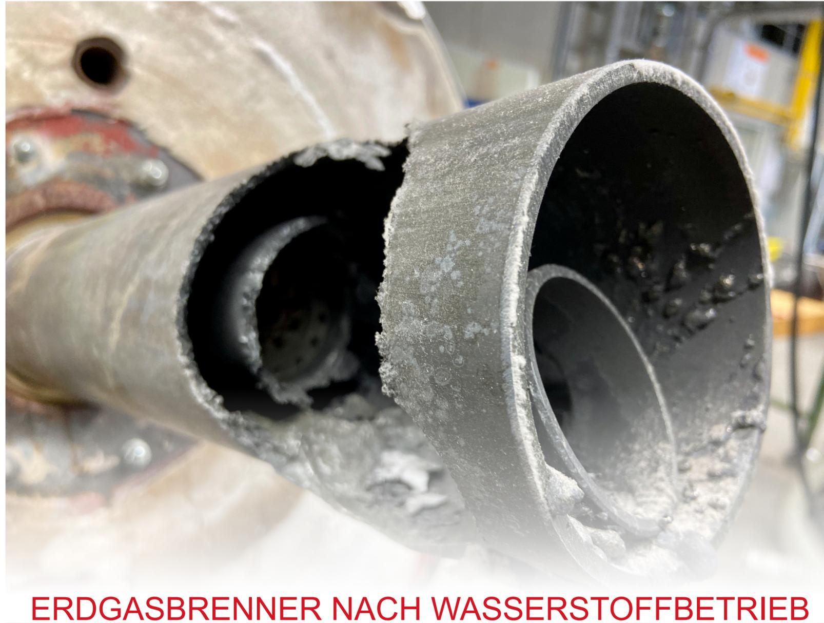
**ERDGASBRENNER NACH WASSERSTOFFBETRIEB**
